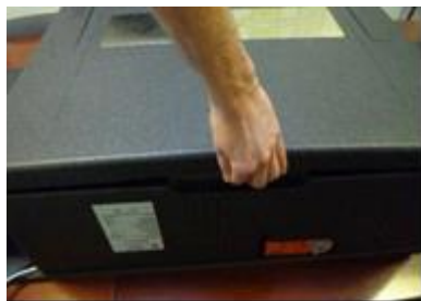
De deur van de unit voorzichtig te openen, geleidelijk vanaf één kant. Begin vanaf de ingangszijde van de bedrading.
